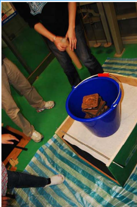
模擬交通載重，加載 25kg，紙牆仍然相當穩固
