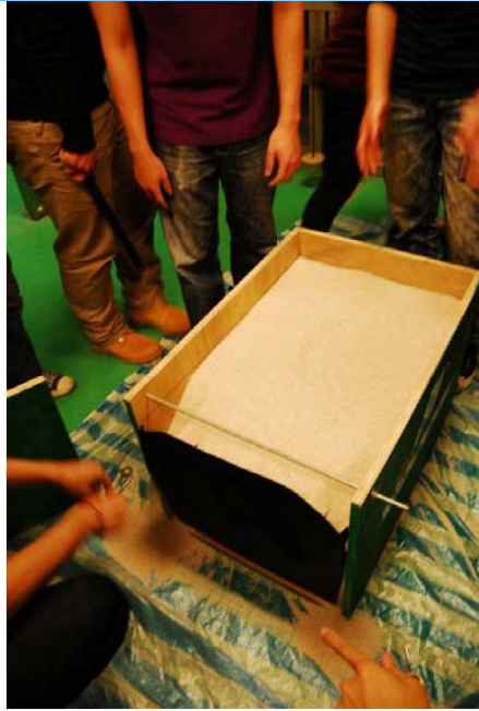
失敗案例，上部加勁材斷裂，牆面與木箱間開裂
