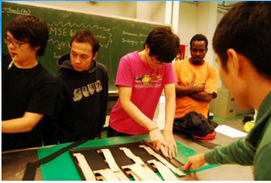
以壁報紙為牆面，牛皮紙為加勁材 製作紙牆面
