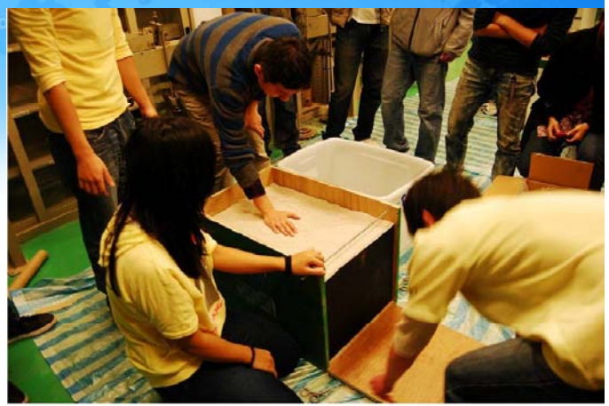
當砂土回填自設計高度，拆除木箱面板，此時所有土壓荷重皆由紙牆面承受。 若設計或施工不良，紙牆面將會因承受不了荷重而倒塌
